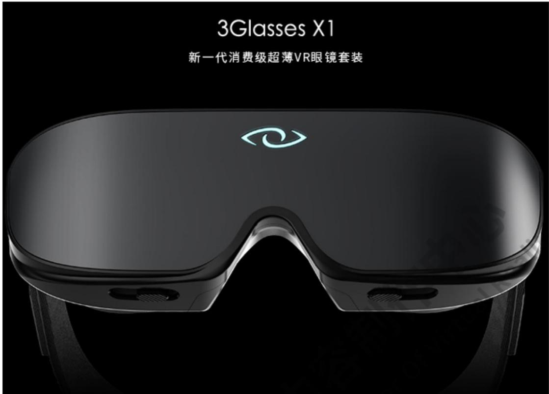
3Glasses X1（套装）是3Glasses在2019年推出的，主打轻薄时尚的消费级VR头戴眼镜。3Glasses X1主打轻薄设计，标称裸机重量小于150g，机身厚度仅为23.5mm。显示方面，3Glasses X1配备2个2.1英寸短焦LCD屏幕，单眼分辨率为1200×1200，整体显示分辨率为2400×1200（806PPI），视场角106°，刷新率90Hz，响应时间6ms，还支持600°的屈光调节，兼顾近视人群。
