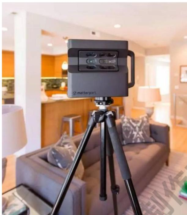
新一代 Pro2 3D 摄像机，与上一代产品 Pro 3D 摄像机相比，这一代产品引入了 4K 摄像头，在拍摄的全景图像的画质上得到了质的提升；更配备了一个 GPS 芯片，可以更容易的匹配房间的地理位置和拍摄的全景信息。Pro2 3D 摄像机的定价为 3995 美元，比上一代产品便宜了 500 美元，同时增加了更多的新功能。Pro2 的三个镜头都得到了升级，可以拍摄 4K 分辨率的 2D 图像，并生成分辨率 8092\*4552 全景画面（3600 万像素），而上代产品的分辨率为 1280\*720（920 万像素）。新相机的重量为 3.4kg，每次需要充电 4.5 小时，可以连续工作 8 小时。
