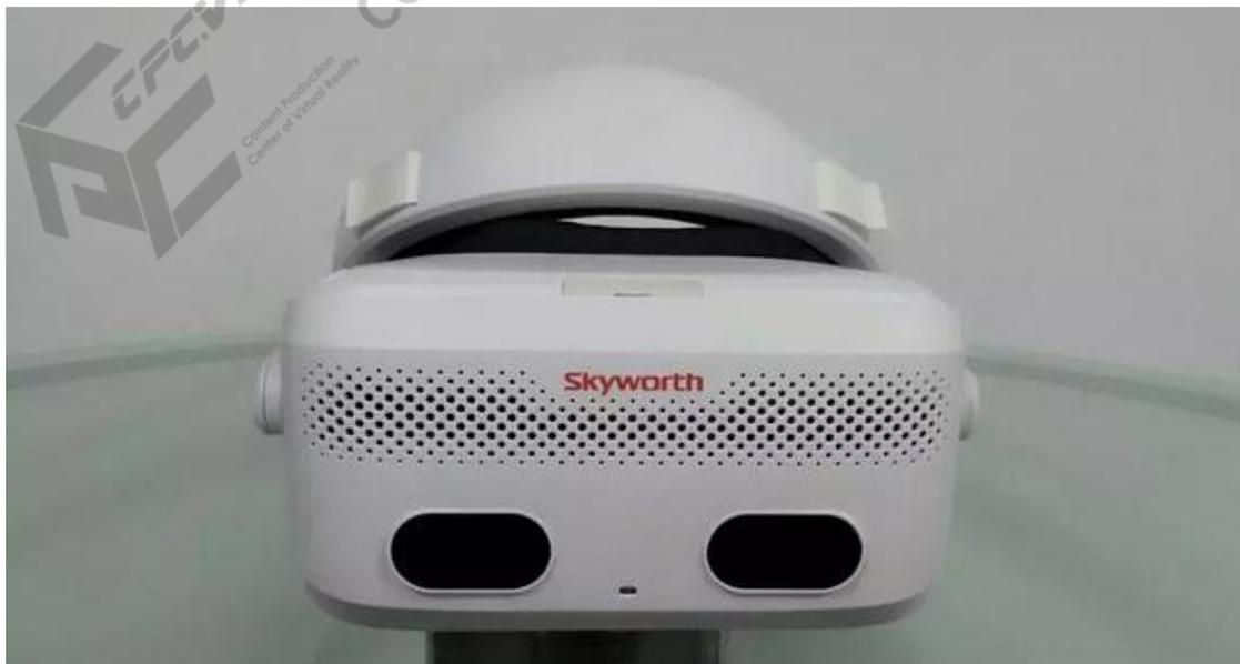
创维 S8000 VR 一体机采用三星 Exynos 8895 芯片，GPU 采用 ARM 的 Mali G71，视场角达 110°，刷新率 90Hz，分辨率为 3K。并配备 4GB 内存+64G 闪存，支持最高 256GB SD 卡拓展。创维这款一体机在机体正面配备了两个摄像头，从而实现 inside-out 追踪技术，目前售出的版本支持 3DoF。这款一体机最大的特点就是能够支持 8K/4K 视频硬解码。
