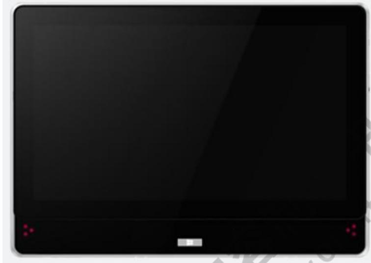
眼控平板电脑一体机是 Windows 平板电脑与眼控仪结合的最新一代高精度、遥测式沟通辅具产品，针对因残疾、损伤等原因导致语言沟通或者使用电脑受到影响的群体，提供智能的辅助沟通功能。使用者无需穿戴任何设备，只要通过眼部运动就可以实现对计算机系统的非接触式控制。通过内置软件的虚拟键盘可实现文字书写并且发音朗读，也可以实现传统鼠标操控电脑的功能。
