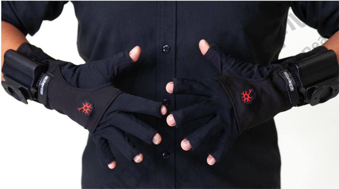
无线手套可以记录简单的手势，如指向，抓住，打孔或更复杂的动作，如乐器演奏和手语。你也可以捕捉到手对地的动作，如车轮，翻转和倒立。作为感知神经元工作室惯性系统的附加功能，每个手套都有 6 个 9 自由度的 IMU 传感器。售价 1499 美元。
