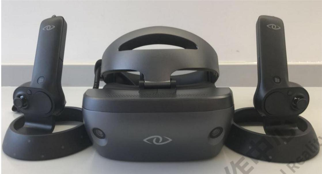
2017 年 12 月,3Glasses 公布了 3Glasses 最新硬件产品 3Glasses 蓝珀 S2。3Glasses S2 使用的是两块分辨率为 1440\*1440 的屏幕（相加为 2880\*1440），屏幕材质为 LCD。3Glasses S2 的屏幕刷新率最高可达 120Hz，更高级别的刷新率可以有效提升画面的连贯性，降低 VR 的眩晕感。定位摄像头分别列于两侧，取消了传统将摄像头单独位列的用例，摄像头采用了广角镜头，同时也是传感器，通过它可以侦测空间范围内的移动变化，支持 Inside-out 空间定位模式。
