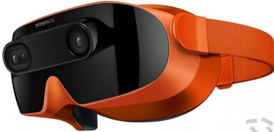
MOVA 是一台 6DoF+3DoF 模式的 VR 一体机。从外型来看, XRSPACE MANOVA VR 一体机设计轻巧便携, 无线束缚, 能实现随时随地畅玩; 从配置来看, 其内置高通骁龙 845 移动平台为性能做支撑, 头显搭配深度摄像头支持 6DoF 空间定位及手势识别, 同时可搭配 6DoF 手柄使用, 兼顾多种交互方式; 内存 6GB; 单眼分辨率 1440\*1440, DPI 为 702, 刷新频率 90Hz, 呈现出更清晰丝滑的视觉效果。支持 WiFi、5G、LTE(4G) 网络, 随时随地随心切换网络自由开启虚拟世界; 重量 470g, 轻便易携带。
