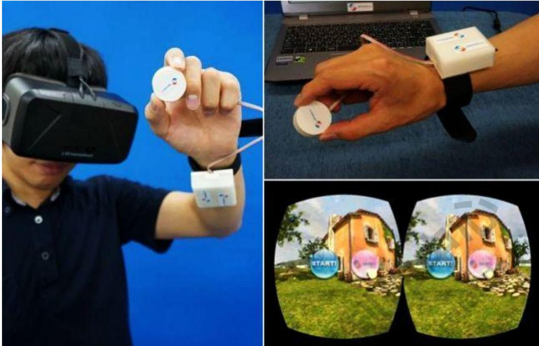
除了用户自己的双手之外，3DHaptics 控制器使用振动来产生外力的感觉，推动或拉动你的手在特定的方向。它具有明显的方向性，闭上眼睛，根据用户选择随机指示，能够 100% 准确地感知预期的方向。3DHaptics 反馈与视觉反馈相结合的效果令人惊讶。
