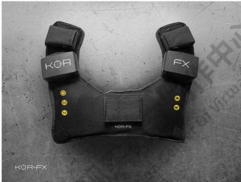
Immerz 在这款可穿戴游戏外设上使用了先进的 4DFX 技术，能将声音变为声音触觉，让玩家体验到在射击游戏中被子弹击中的感觉，或者是在运动游戏中受到对手碰撞受伤后的疼痛感。
