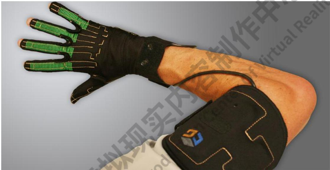
Cyberglove 通过其前所未有的弹性传感技术积累了丰富的经验，专业知识和可靠性。通过对新的 HyperSensor 专利技术进行重大改进，使手部动作捕捉的数据清晰，可重复，甚至更加准确。新的 Wi-Fi 通信提供了更好的连接性，并使设备操作范围超过 100 英尺。
