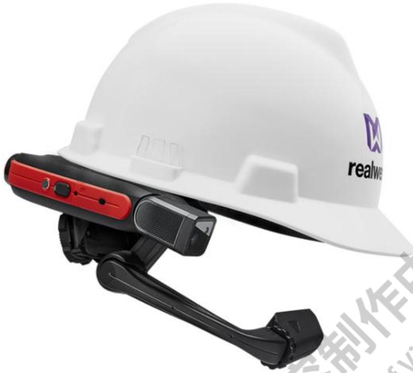
HMT-1Z1 被称为世界上第一款商用安全可穿戴设备，是一款获得 ATEX Zone 1/CSA C1-D1 认证的头戴计算机，并通过中国 PCEC、国际 IECEX、北美 NEC500 认证。HMT-1Z1 配备 2.0 GHz 8 核高通 Snapdragon 625 及 Adreno 506 GPU 芯片组，搭配 WearHF 接口，搭载 2GB 内存 Android 6.0.1 操作系统。HMT-1Z1 支持 16GB 内部存储以及 MicroSD 插槽。提供 8—10 小时的电池寿命，20 度视野，1 米固定焦点显示，分辨率为 854×480。
