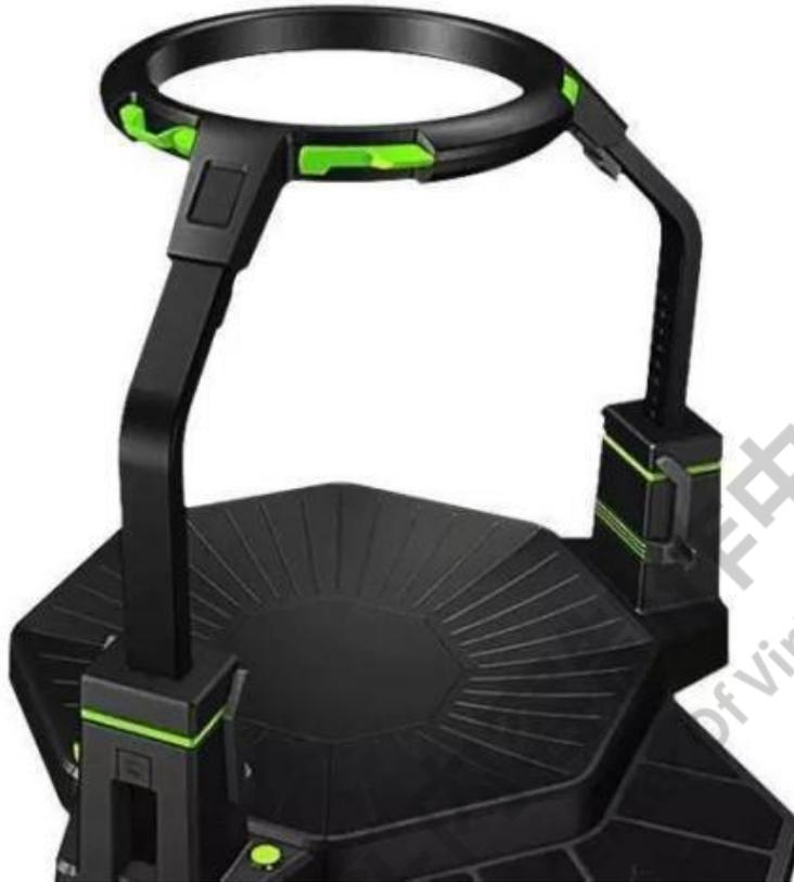
普通的跑步机主要体现速率和距离这两个维度的数据，但 Omni 加入了方位这一因素，让用户可以自由的在 Omni 上转向。Omni 的底盘被设计成表面是一个凹陷圆形曲面的带有很多细小凹槽的光滑跑道，直径为 122cm，上方是一个 142cm~195cm 的可调节支架，总重量为 50 公斤。用户需要穿上特制的鞋子在 Omni 的跑道上运动。鞋子的底部有一个与凹槽匹配的锥状物，Omni 用它来稳定脚步的运动，防止位置偏移等状况的发生，这双鞋子的底部的脚尖部位同样有非常高的摩擦力来保证人们在上面运动时的平衡。依靠这种设计，Omni 既能让用户在上面自然的行走，同时还能精确的记录数据。Omni 的支架应当被调整到腰部的位置，通过安全带与人体连接，使其不会滑倒，保证人们在戴上 VR 眼镜，无法用视觉感知周边环境时的安全。
