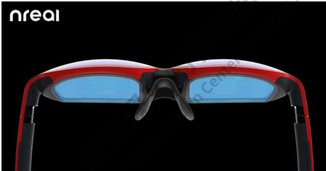
Nreal Light 是国内首批面向消费级市场的 MR 眼镜产品之一。产品以外观时尚, 机身轻薄, 机身重量仅 88g, 单眼分辨率达到 1080P, 色彩更加清晰。结合定位追踪, 产品能够实现虚实结合的沉浸体验, 并且支持与 5G 手机直连。用户可以通过 USB Type-C 数据线将 Nreal Light 与 5G 手机连接——借用手机的电源与算力, 手机在连接之后秒变手柄, 用户可将其用于操作及交互。
